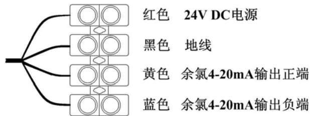
图 7 变送器接线图
